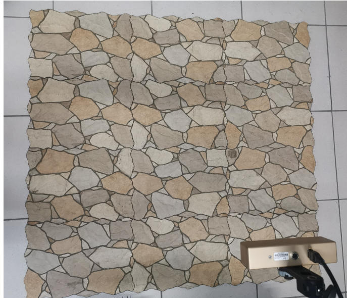
Figura 4.4: Superficie utilizada dentro del campo de visión de la cámara estereoscópica atada rígidamente a la plataforma robótica dentro del entorno controlado.
