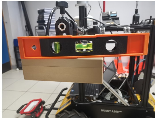
Figura 4.7: Inclinación vertical de la cámara estereoscópica atada rígidamente a la plataforma robótica dentro del entorno controlado.
