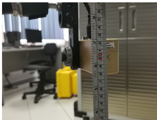
Figura 4.8: Altura con respecto al suelo de la cámara estereoscópica atada rígidamente a la plataforma robótica dentro del entorno controlado.
