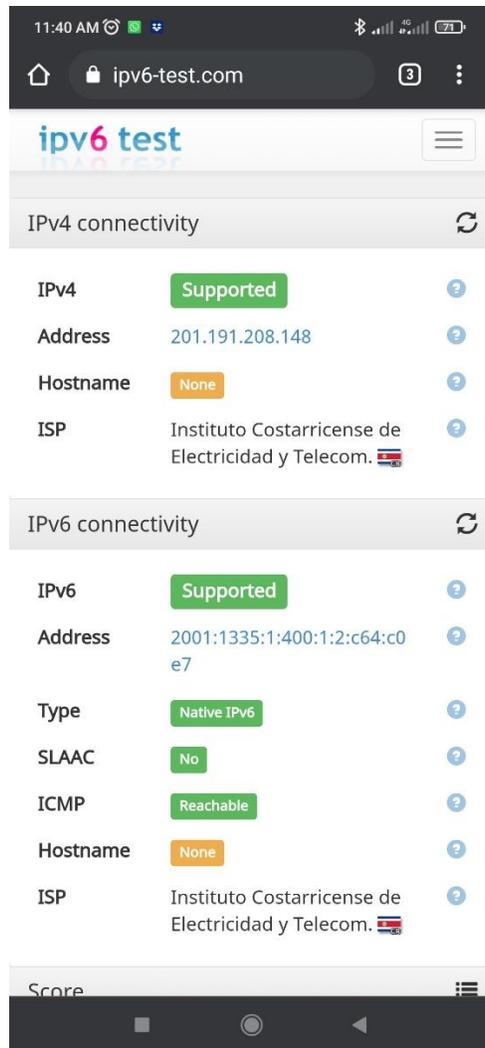
Figura 34: Estado conexión desde sitio Web ipv6-test.com. Caso IPv4 / IPv6 Dual.
