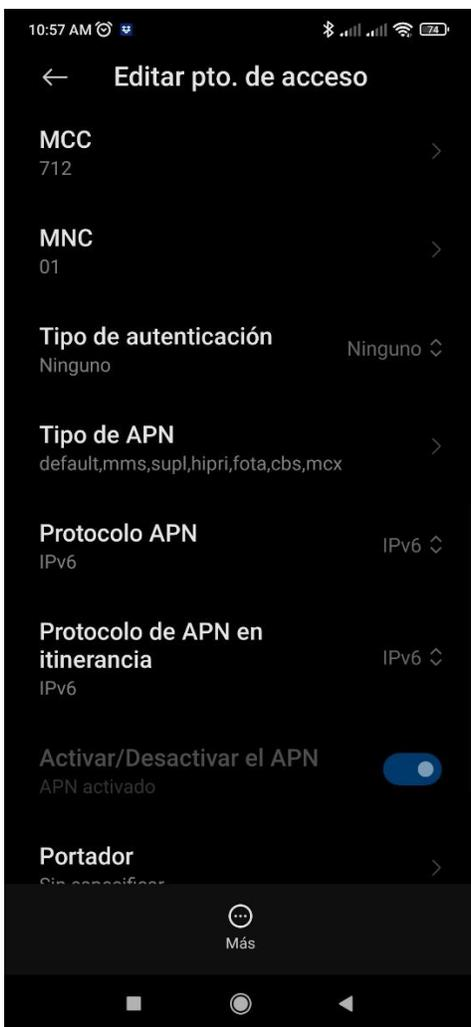
Figura 27: Configuración del APN en el dispositivo del cliente, IPv6 puro
