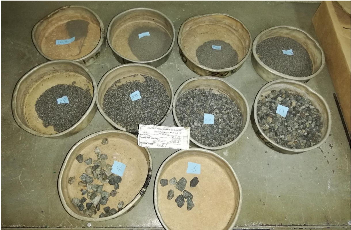
Figura 22. Fotografía del agregado del material asfáltico perfilado luego de la extracción del asfalto
