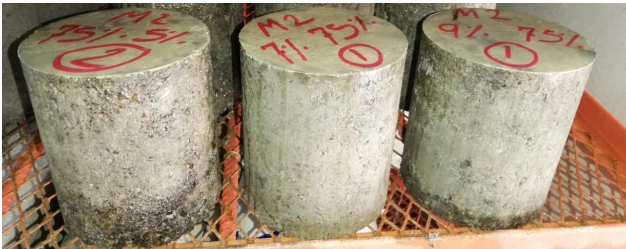
Figura 40. Comparación de las pastillas elaborados con distintos porcentajes de cemento y 75% de material asfáltico perfilado
