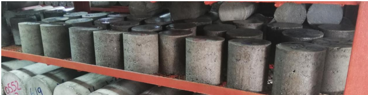
Figura 35. Proceso de ganancia de resistencia de las pastillas de BEC en la cámara húmeda
