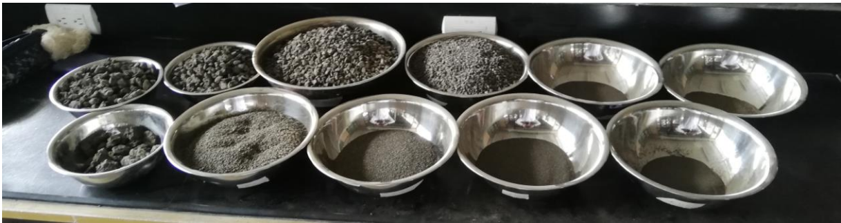
Figura 15. Fotografía de la separación granulométrica aplicada a uno de los agregados granulares
