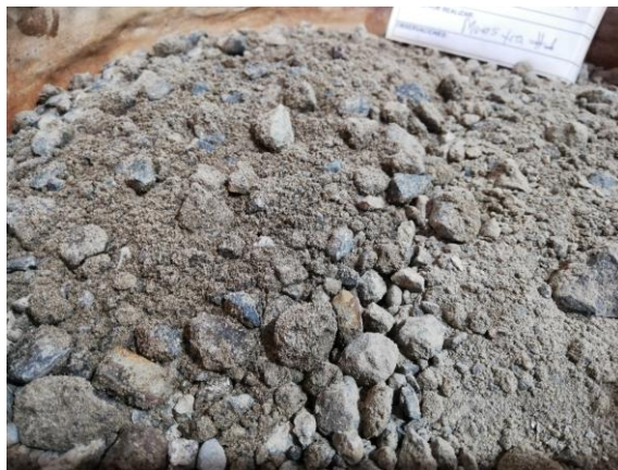
d) Agregados liberados del asfalto
