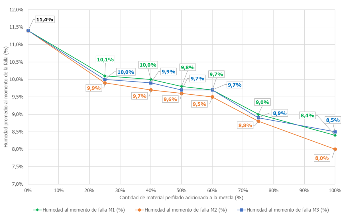
Figura 39. Gráfico comparativo de humedades al momento de falla, variando el contenido de material asfáltico perfilado
