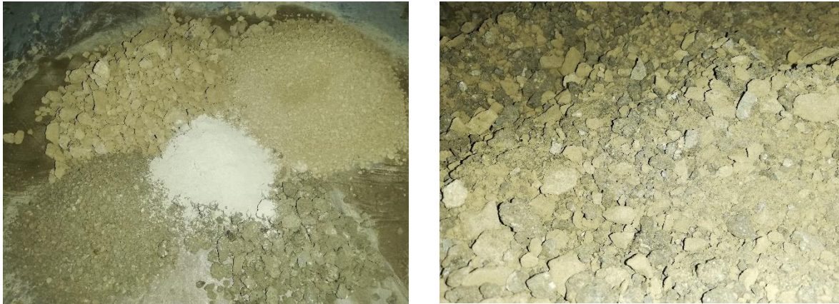
Figura 28. Mezcla de una de las combinaciones de agregados utilizados para el diseño de mezcla patrón
