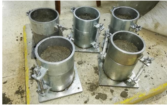
b) Compactación de pastillas de BEC
