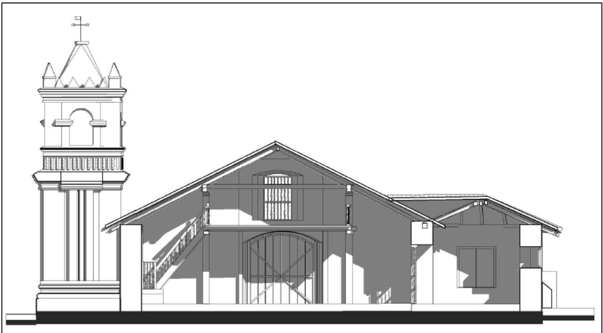
Figura 23. Corte transversal de la estructura del templo colonial resultado del modelo BIM
