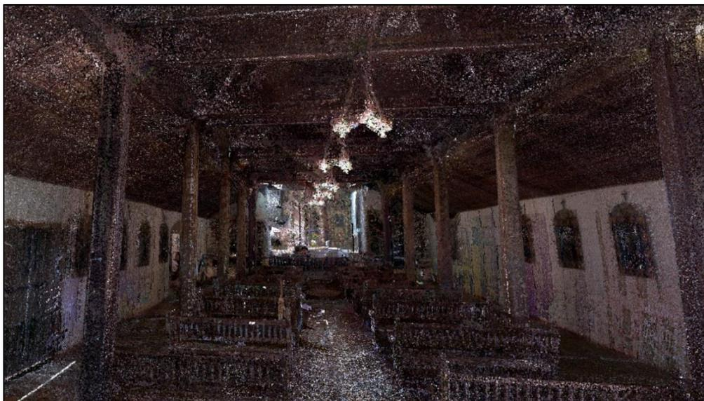
Figura 9. Vista de interior de la nube de puntos obtenida a partir del escaneo láser en el templo
