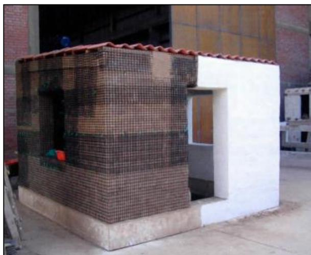
Figura 79. Modelo de muro reforzado a escala real para ensayo dinámico
