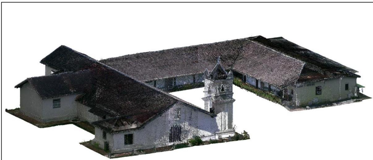
Figura 10. Vista sureste 3D de la nube de puntos en la plataforma de modelado BIM
