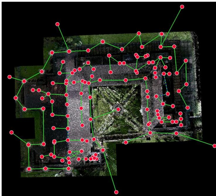
Figura 6. Vista en planta de los estacionamientos y su respectivo enlace después del alineamiento
