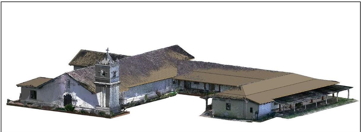
**Anexo 4.** Vista 3D del modelo realizado en Revit más la nube de puntos obtenida del escaneo láser
