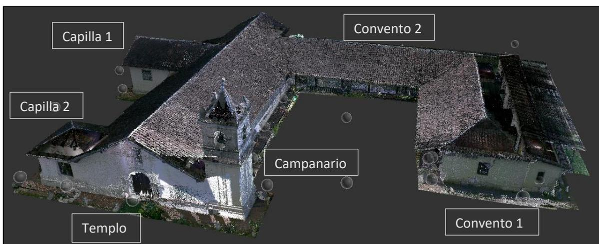
Figura 7. Vista 3D de nube de puntos global obtenida a partir del escaneo láser
