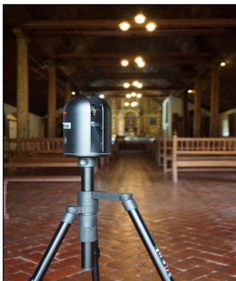
Figura 4. Herramienta láser en proceso de escaneo del interior del templo
