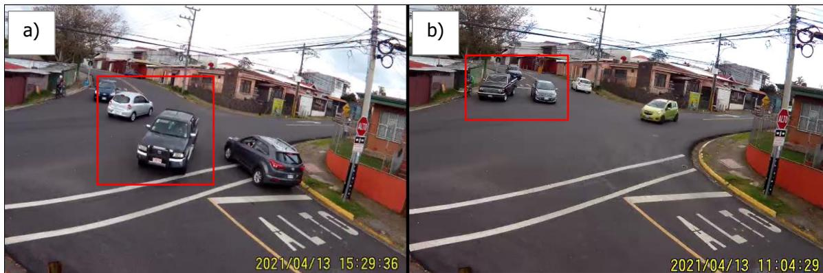
**Figura 106.** Ejemplo de comportamiento de los usuarios en la intersección de Montes de Oca: a) Dos carriles en acceso oeste, b) Giros izquierdos simultáneos en vía principal
