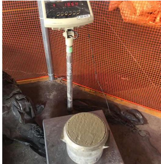
Figura 22. Determinación del peso unitario del concreto fresco
