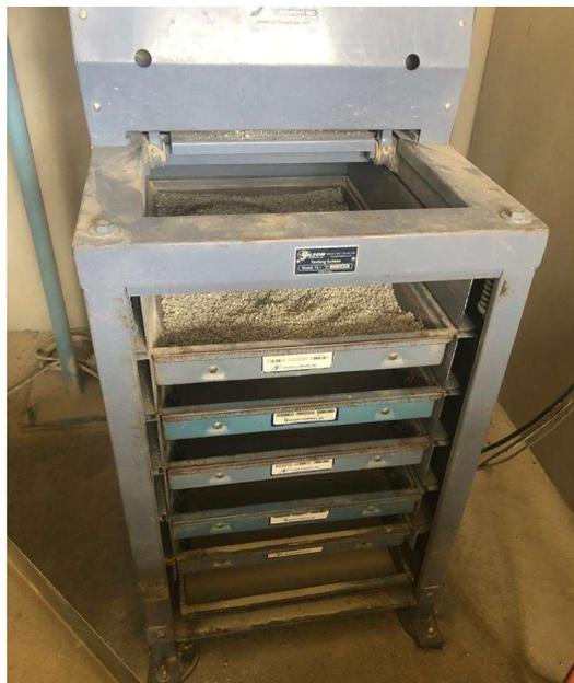
Figura 12. Tamizadora de agregados
