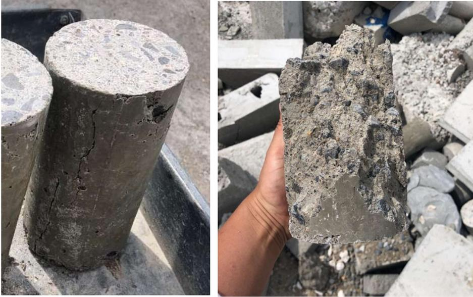
Figura 27. Detalle de falla tipo 3.
