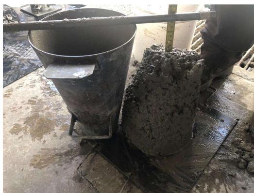
Figura 20. Asentamiento en el concreto mediante el Cono de Abrams
