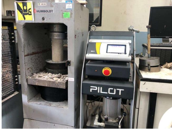
Figura 25. Maquina ensayo resistencia a la compresión
