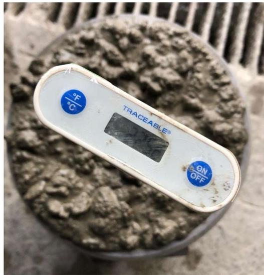
Figura 21. Temperatura del concreto fresco
