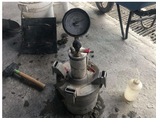
Figura 23 . Cámara de aire vertical
