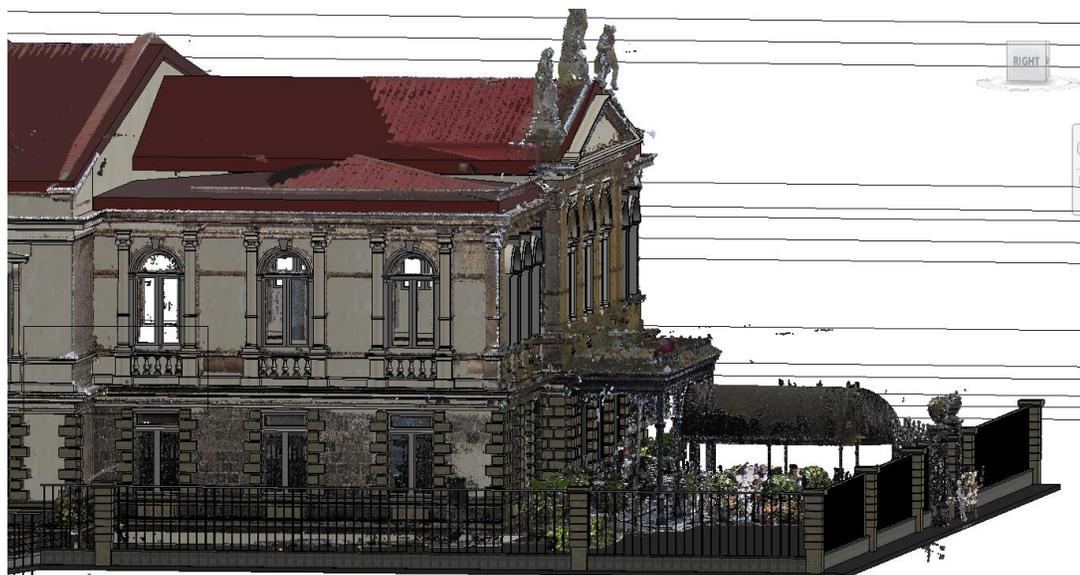
*Figura 66.* Vista de fachada Oeste modelo superpuesto con nube de puntos
