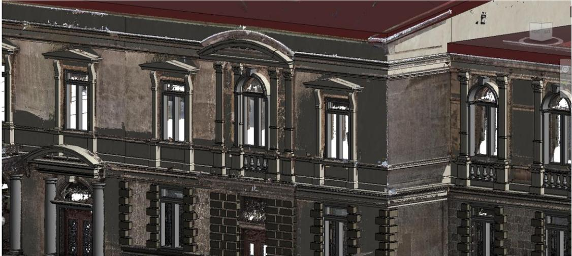
*Figura 67.* Detalles de ventanas del modelo superpuestos con la nube de puntos
