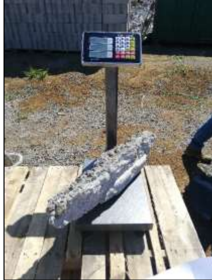
Figura 24. Residuo de concreto premezclado de la etapa de contrapiso, proyecto 2B.
