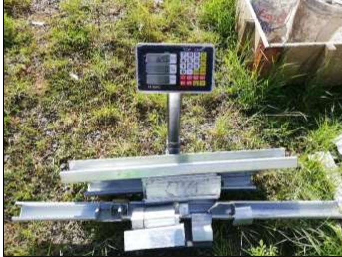
Figura 37. Residuos de acero, estructura de techo proyecto 1B.
