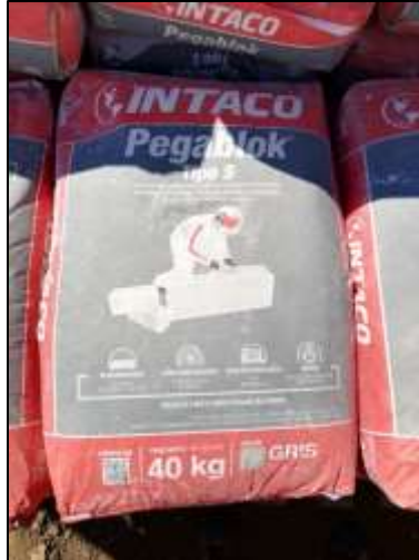
Figura 16. Mortero de pega utilizado en la empresa A y B.
