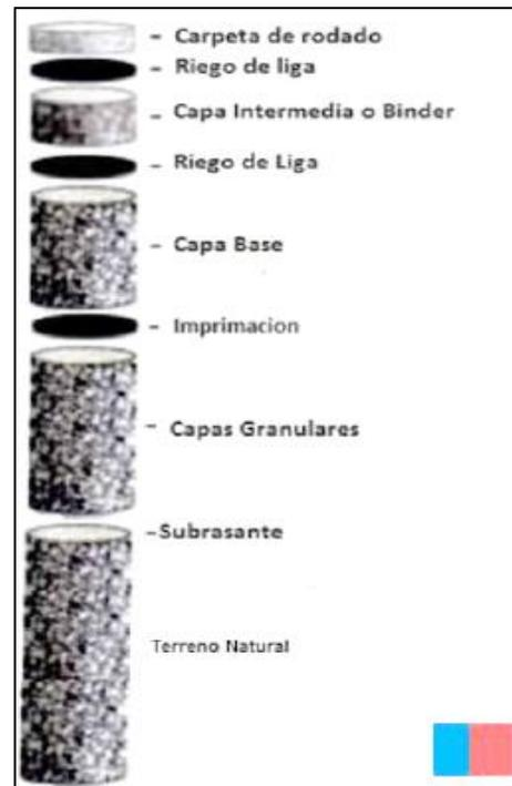
Figura 3. Posibles capas de un pavimento flexible
