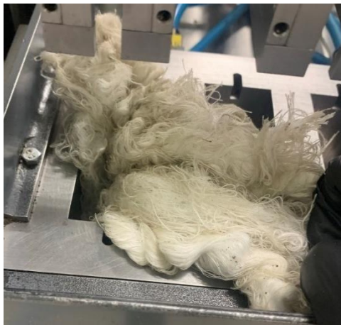
Figura 35. Limpieza del molde con la mecha
