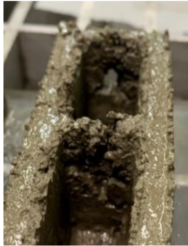
Figura 132. Agujero en el bloque 3 diseño B1*
