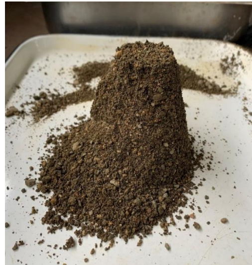
Figura 15. Agregado en condición saturado superficie seca
