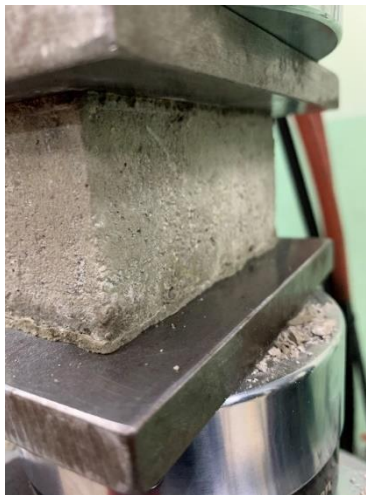
Figura 23. Demostración de placas utilizadas para la falla
