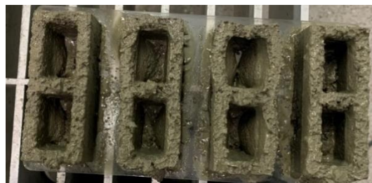
Figura 95. Deformación de la base tanda 2 diseño B2
