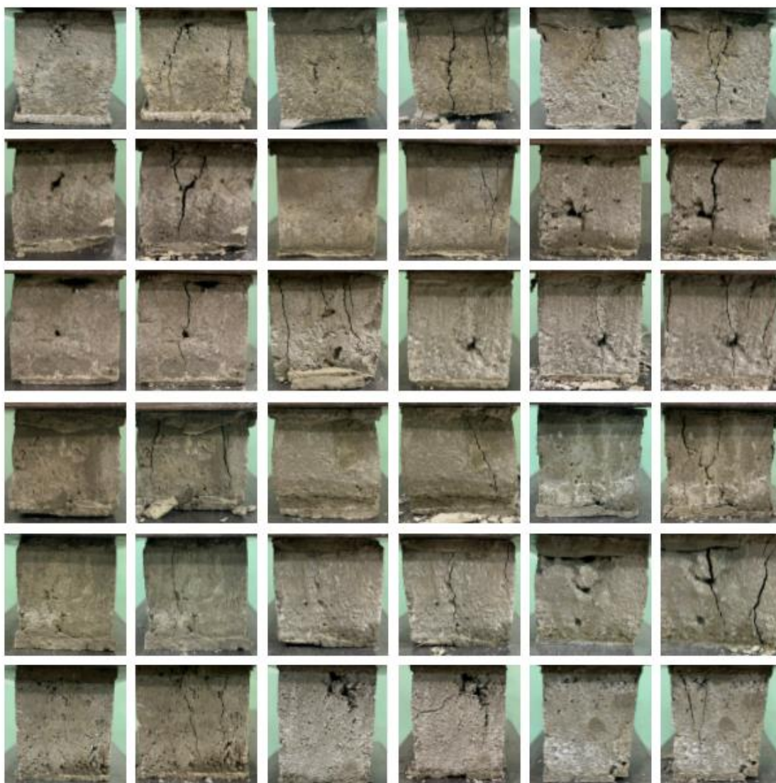
Figura 77. Evidencia de grietas a través de los vacíos de los bloques
