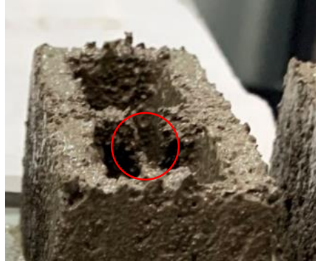
Figura 112. Huevo en zona superior de pared interna de diseño C3
