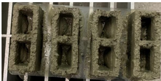
Figura 68. Deformación en la base tanda 2 diseño B2
