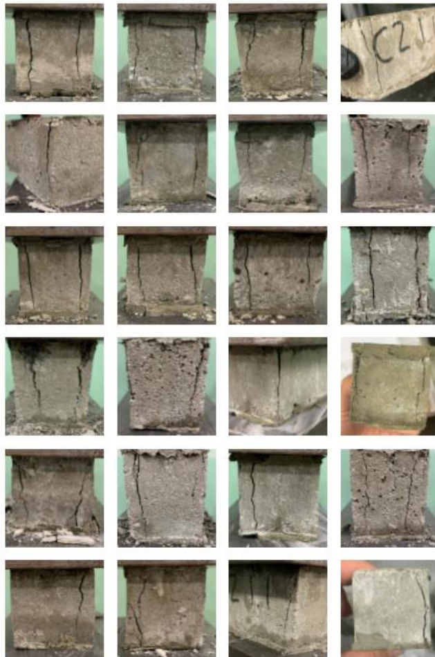
Figura 76. Ejemplos de falla de separación de paredes
