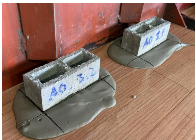
Figura 22. Bloques recién capeados esperando la fragua
