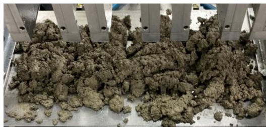
Figura 58. Mezcla muy seca que no es consolidada por vibración diseño C0*
