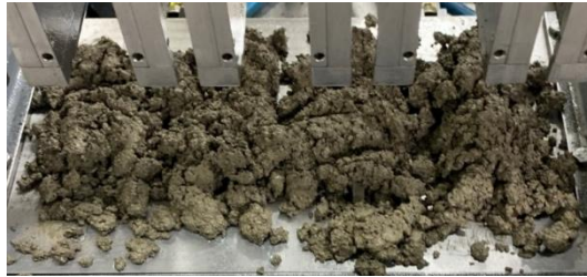
Figura 137. Mezcla muy seca que no es consolidada por vibración diseño C0*
