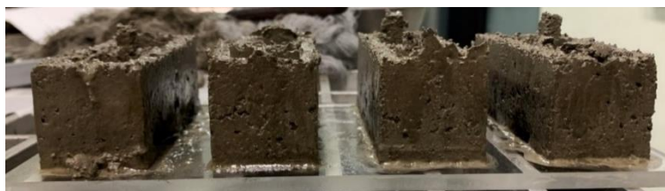
Figura 63. Deformación en la base diseño A1
