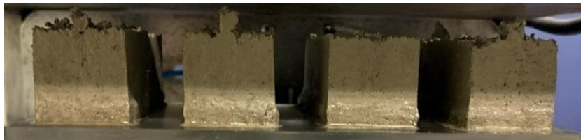
Figura 66. Deformación en la base de tanda 1 diseño B0
