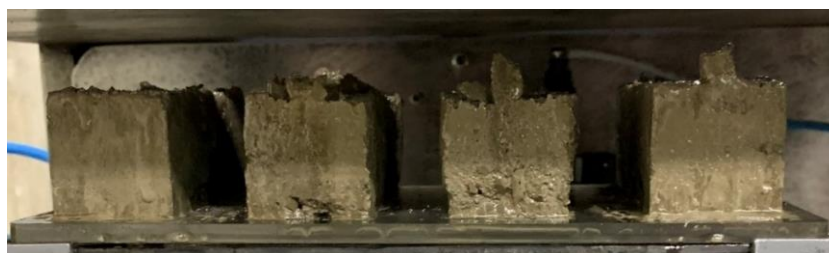
Figura 64. Deformación en la base tanda 2 diseño A3
