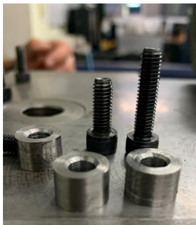
Figura 34. Solución al problema de altura del tope mecánico
