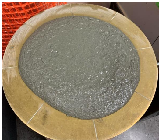
Figura 8. Muestra en tabla de flujo que no cumple con la norma
