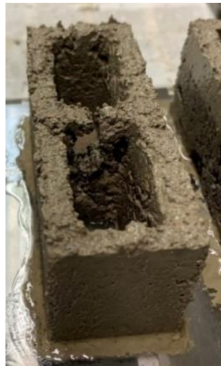
Figura 109. Hueco en bloque de tanda 3 diseño C2
