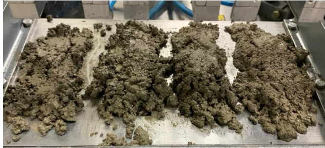
Figura 140. Pasta de diseño C1* que no permite pasar al estampador
