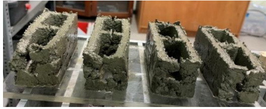
Figura 119. Bloques con huecos en su pared posterior tanda 1 diseño A0*
