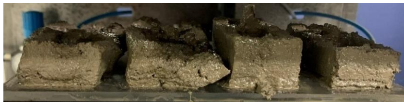
Figura 97. Bloques dañados por disminución en la presión
