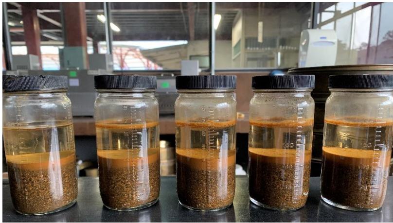
Figura 11. Frascos con agregado recién preparados
