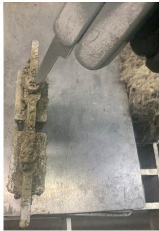
Figura 37. Limpieza de agujero de los núcleos con cuchilla
