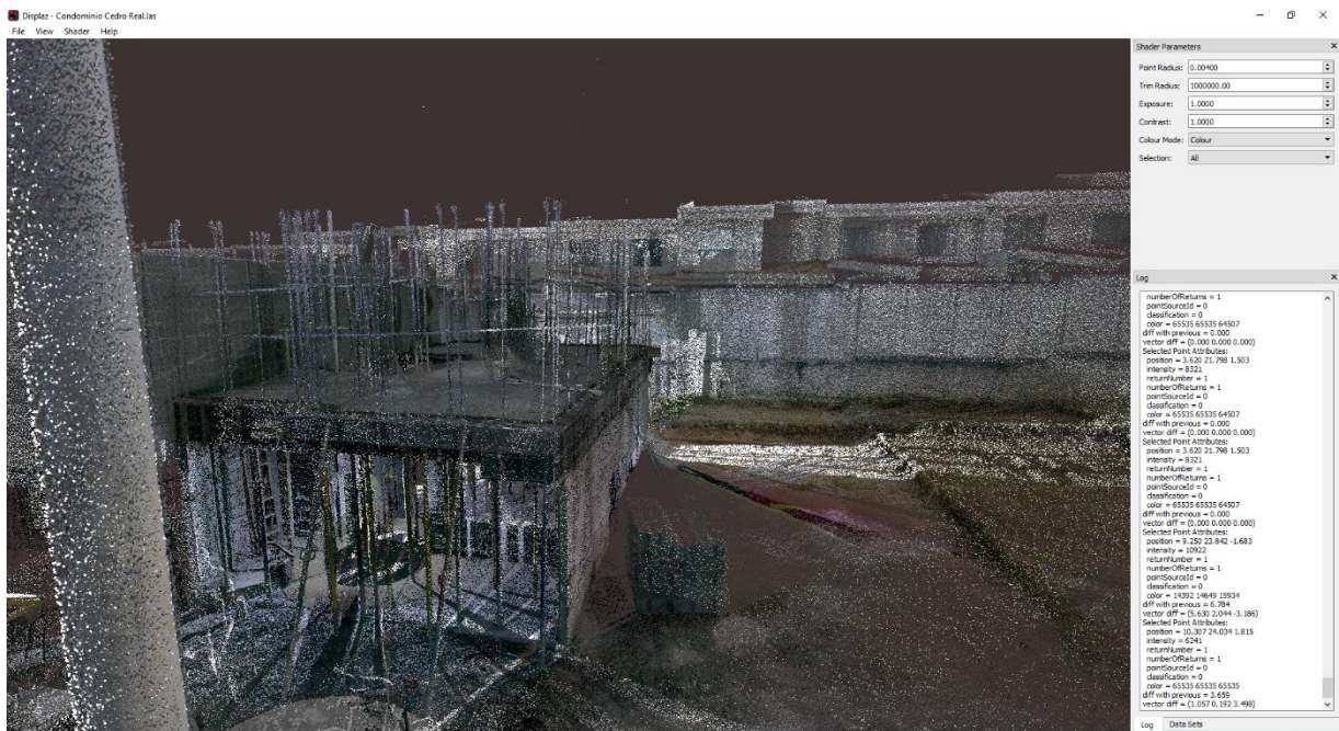
Figura 20. Nube de puntos de una vivienda en la etapa de colado de entrepiso
