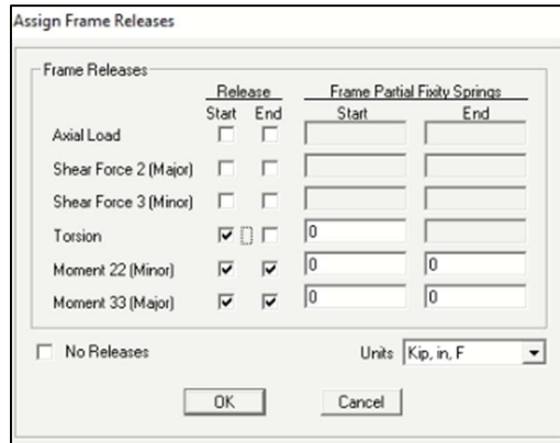
Figura D-7. Modelado de las uniones de los elementos de las cerchas y los componentes transversales.
