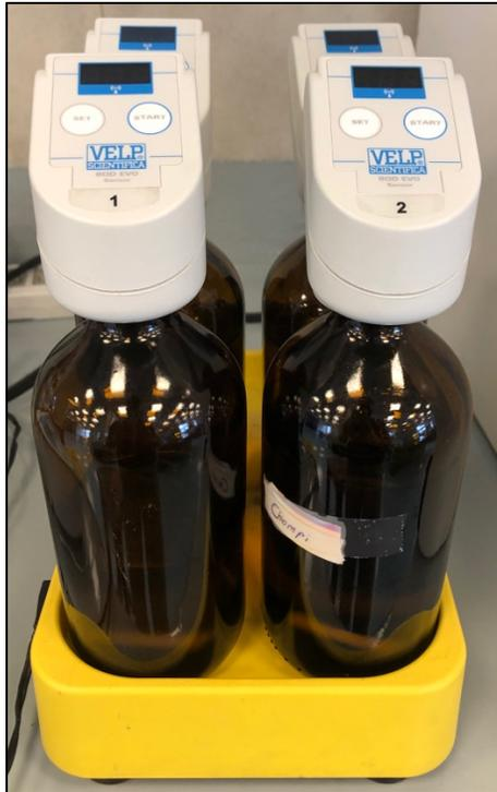
**Figura 152.** Equipo de medición de DBO VELP Scientifica
