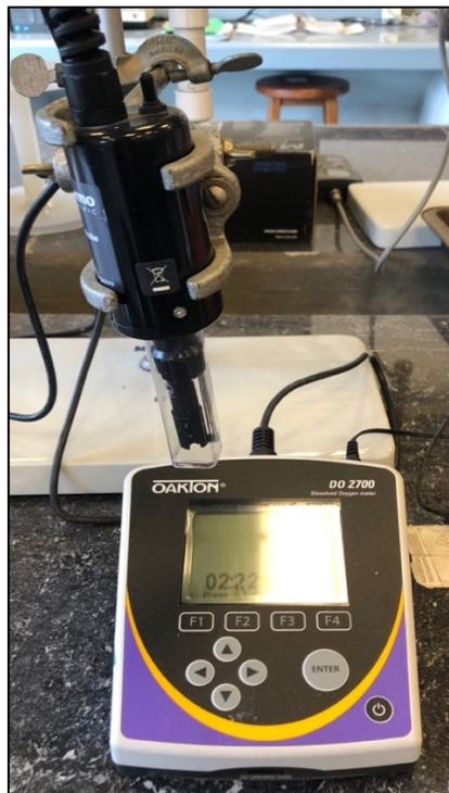
**Figura 164.** Medidor de oxígeno disuelto de mesa marca OAKTON DO 2700
