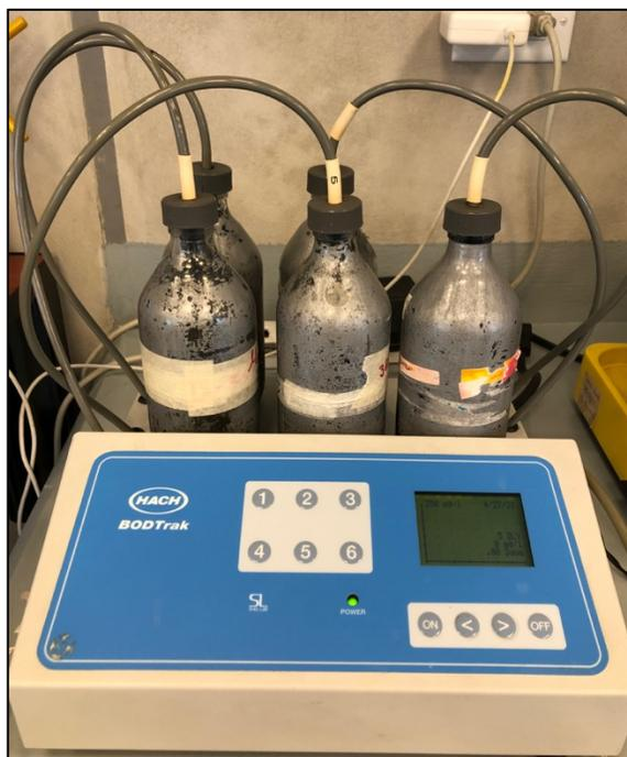
**Figura 151.** Equipo de medición de DBO
