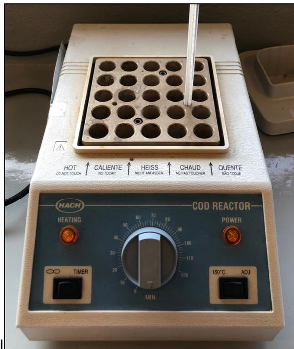
**Figura 148.** Digestor de DQO
