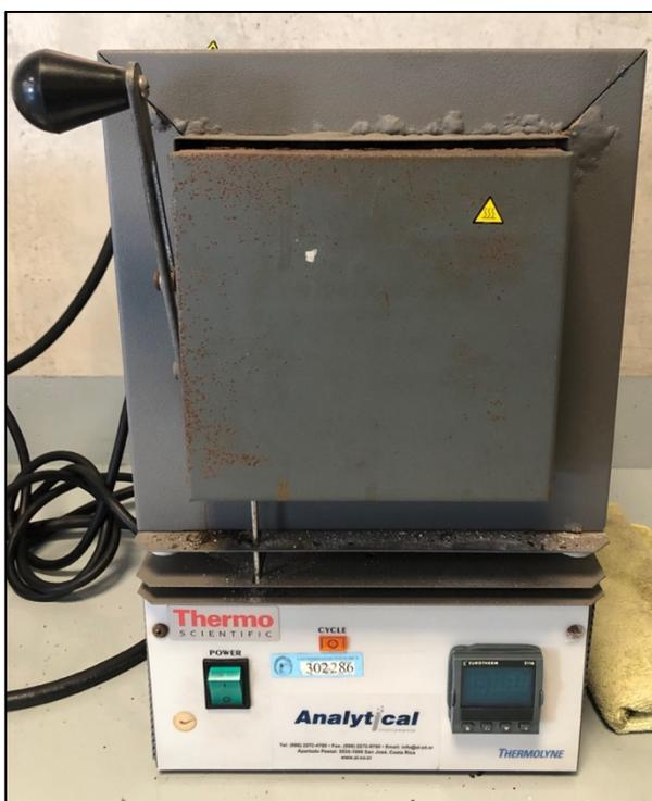
**Figura 158.** Mufla de la marca Analytical
