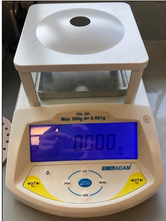
**Figura 156.** Balanza de precisión de marca ADAM
