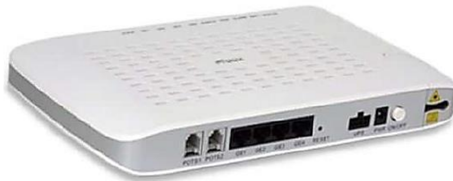
Figura 19. Equipo de terminal ONT Fuente: Extracto del MITE, 2015
