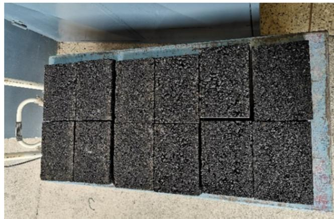
Figura 6. Especímenes listos para aplicar el ensayo.
