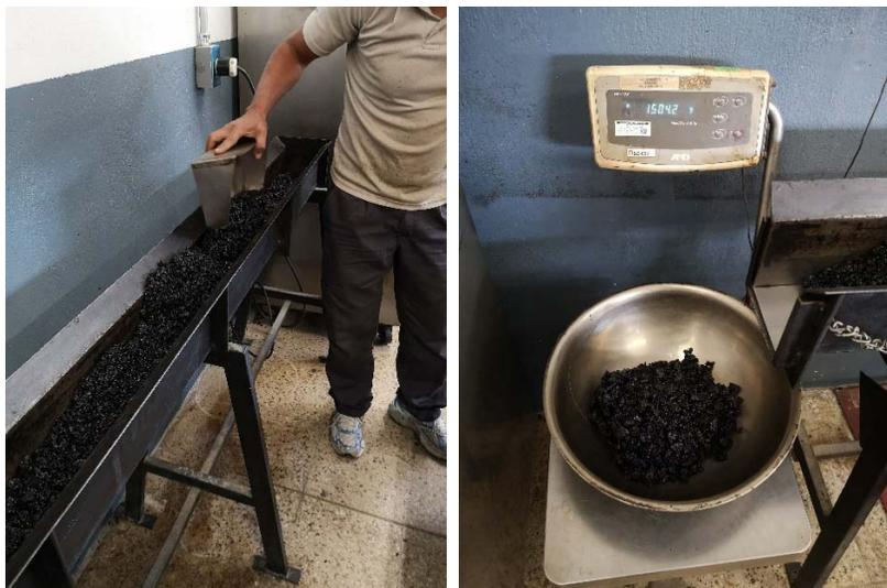
Figura 3. Proceso de cuarteo de la mezcla asfáltica.
