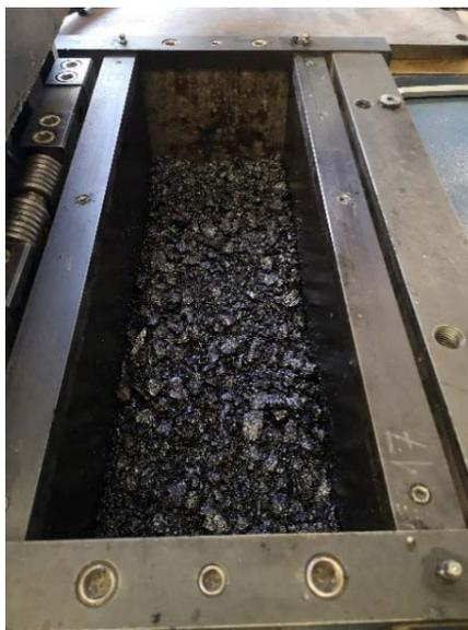
Figura 4. Colocación de mezcla asfáltica en el compactador
