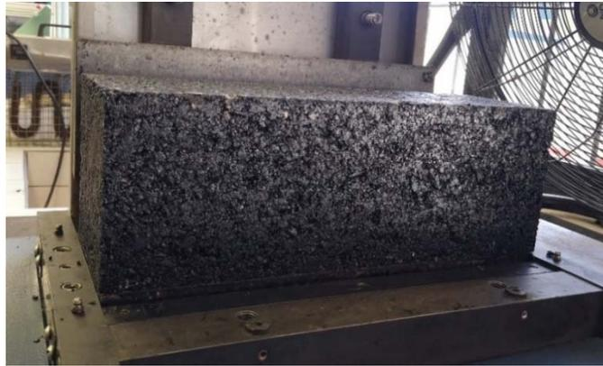
Figura 5. Bloque de mezcla asfáltica compactado a 21 ciclos de carga y 7% de vacíos.
