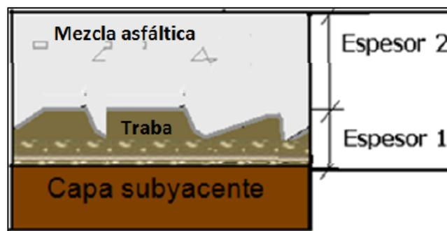
Figura 21. Esquema acerca de la colocación de mezcla asfáltica como "traba" (espesor 1)
