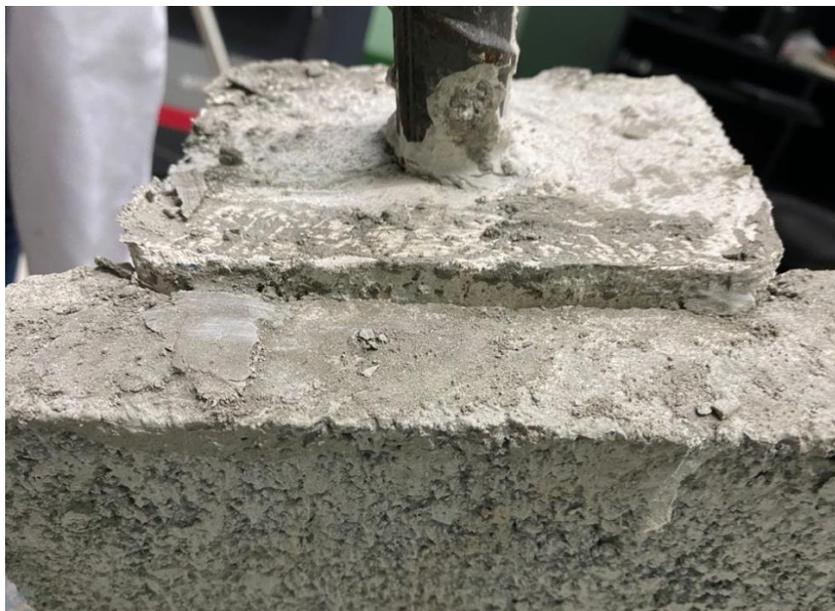
Figura 36. Resultado de la prueba para obtener la interfaz entre el concreto de relleno y el bloque
