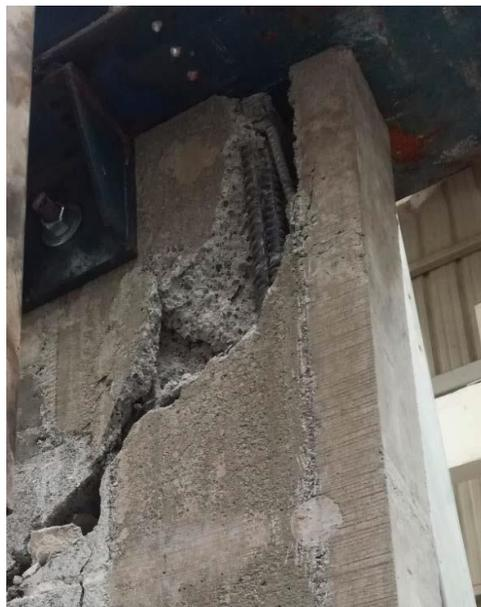
Figura 57. Estado final del nudo viga-columna
