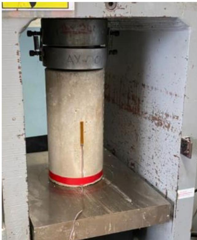
Figura 25. Falla de cilindro de mortero
