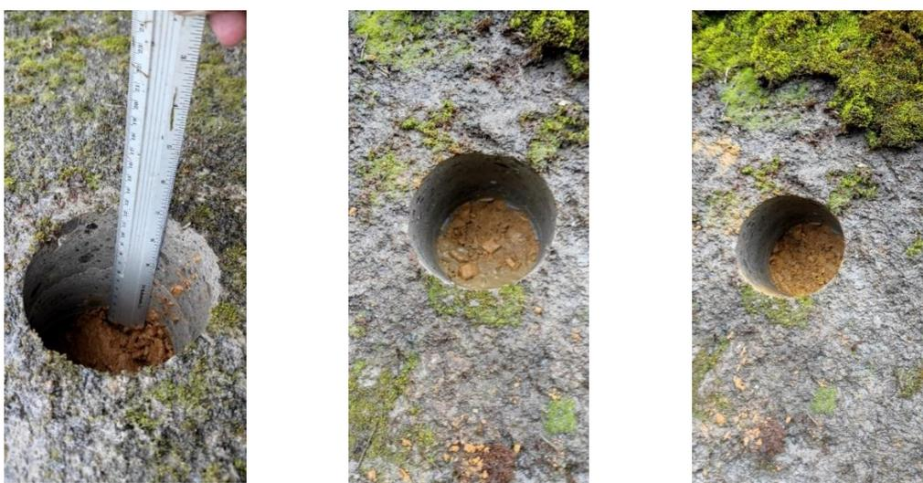
**Figura 43.** Primer núcleo extraído a 0,98 metros de la base, Segundo núcleo extraído a 1,35 metros de la base y Tercer núcleo extraído a 1,51 metros de la base, respectivamente
