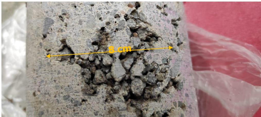
**Figura 64.** Problemas en el interior del concreto
