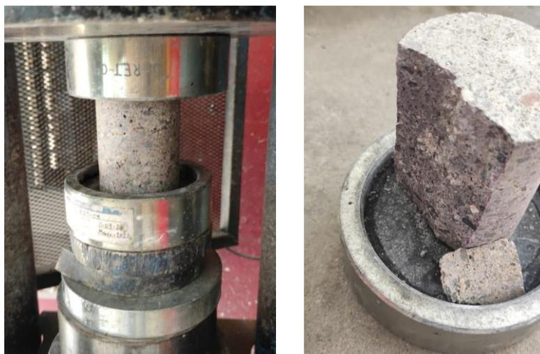
**Figura 69.** Núcleo colocado en la máquina de compresión, junto con su modo de falla
