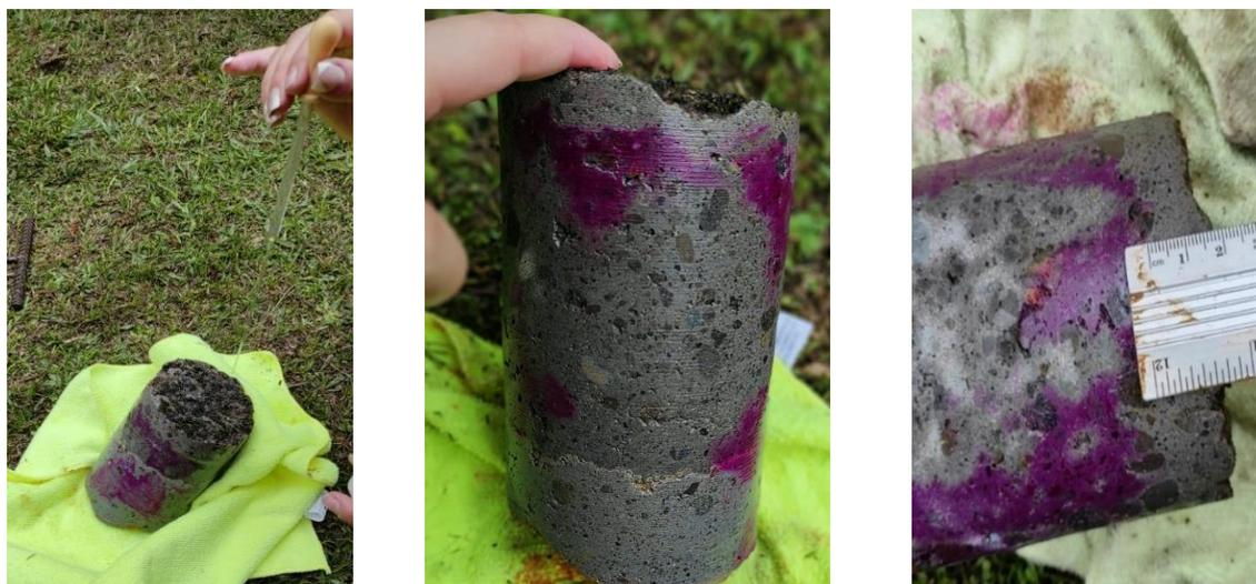
**Figura 50.** Reacción de la fenolftaleína en el primer, segundo y tercer núcleo extraído, respectivamente.
