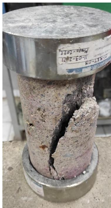
**Figura 59.** Núcleo colocado en la máquina de compresión, junto con su modo de falla
