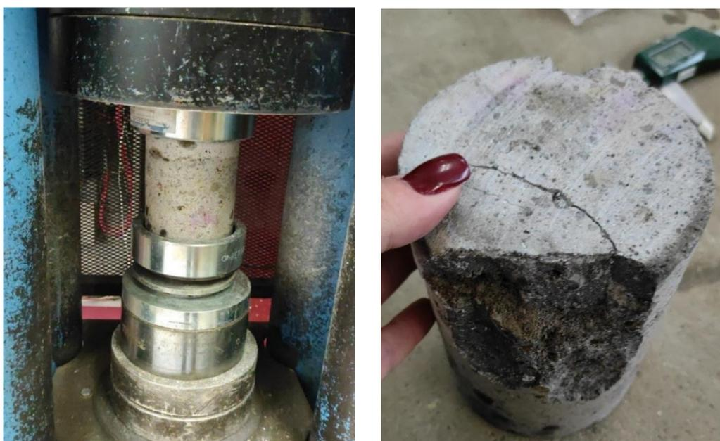
**Figura 45.** Núcleo colocado en la máquina de compresión, junto con su modo de falla
