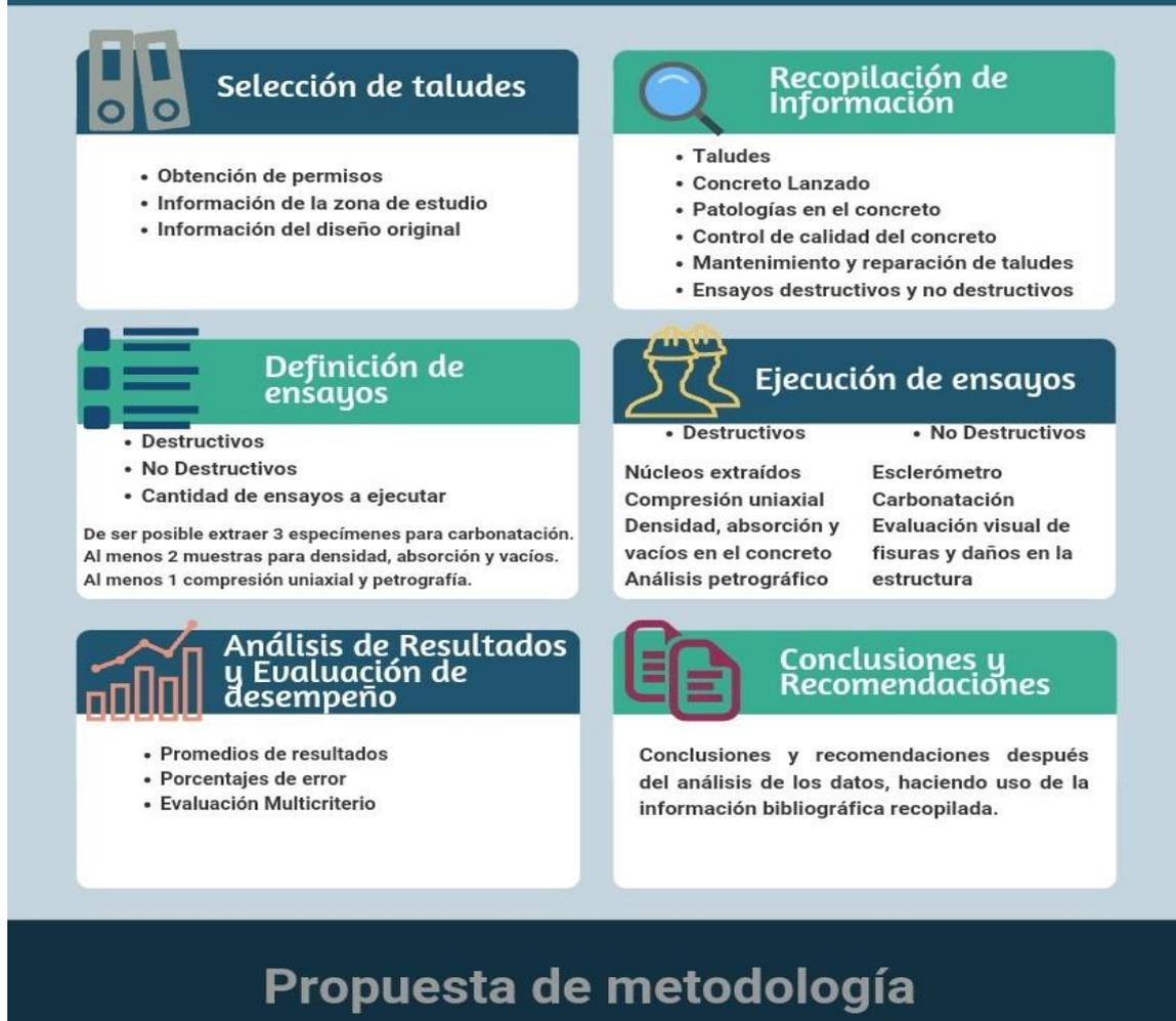
**Figura 81.** Propuesta de metodología de evaluación del desempeño para aplicar en taludes de concreto lanzado
