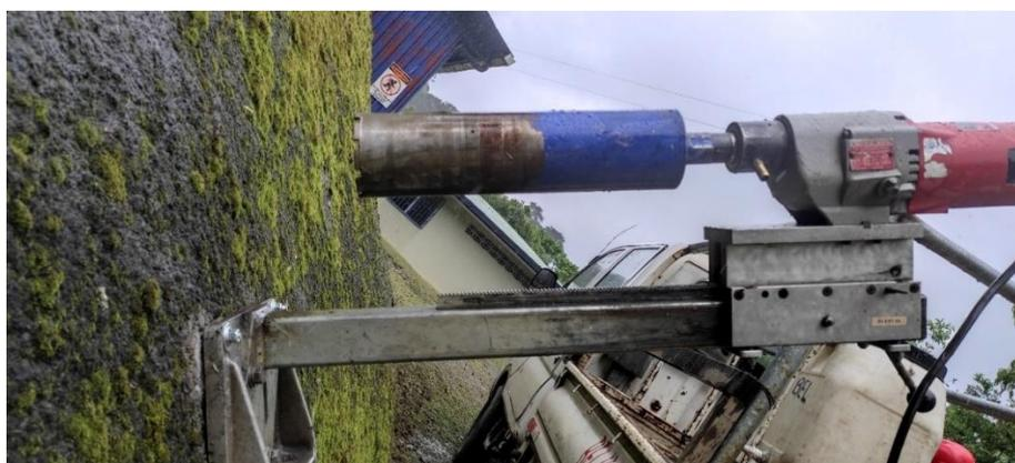
**Figura 42.** Colocación de la máquina extractora de forma perpendicular a la superficie
