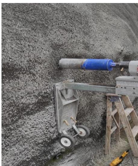
**Figura 55.** Colocación de la máquina extractora de forma perpendicular a la superficie
