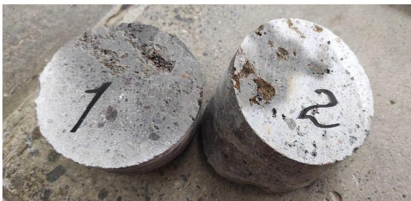
**Figura 46.** Muestras de concreto a ser ensayadas
