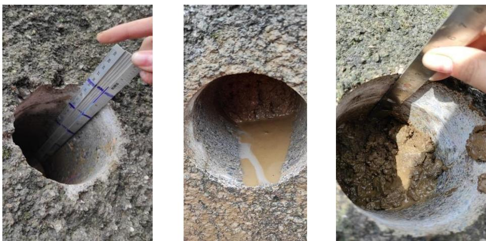
**Figura 56.** Primer núcleo extraído a 1,60 metros de la base a 8,70 metros desde el punto 0+000 m, Segundo núcleo extraído a 1,20 metros de la base a 79,34 metros desde el punto 0+000 m y Tercer núcleo extraído a 1,20 metros de la base a 145,00 metros desde el punto 0+000 m
