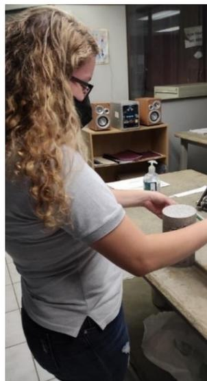
**Figura 58.** Medición del núcleo a fallar, ya cortado, por medio de un vernier
