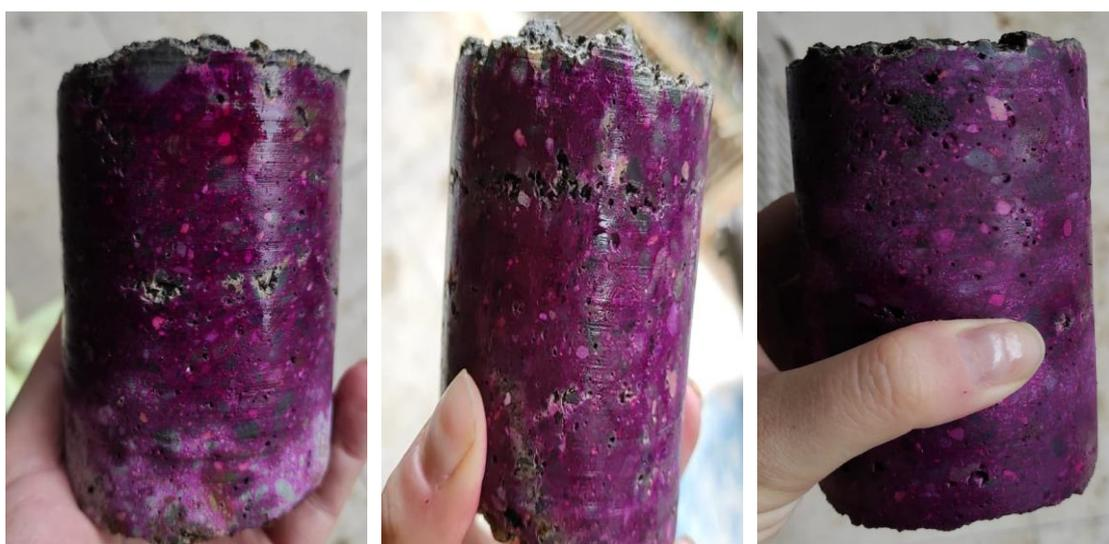
**Figura 72.** Reacción de la fenolftaleína en el primer, segundo y tercer núcleo extraído, respectivamente
