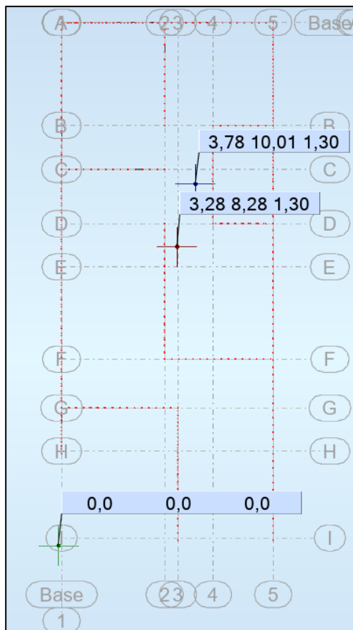
Figura 35. Ubicación y coordenadas del centro de masa y de rigidez para el primer nivel.
