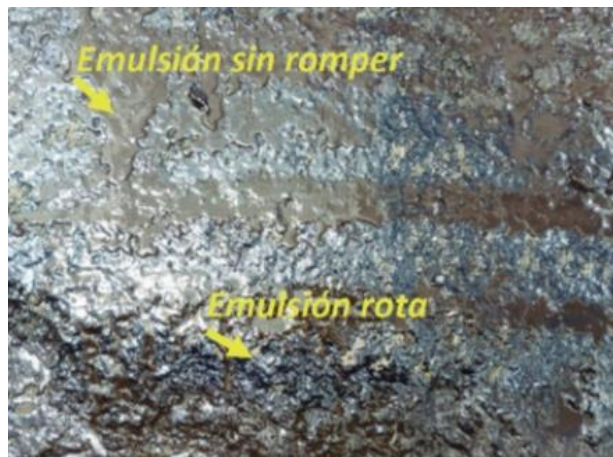
Figura 20. Rompimiento de emulsión asfáltica
