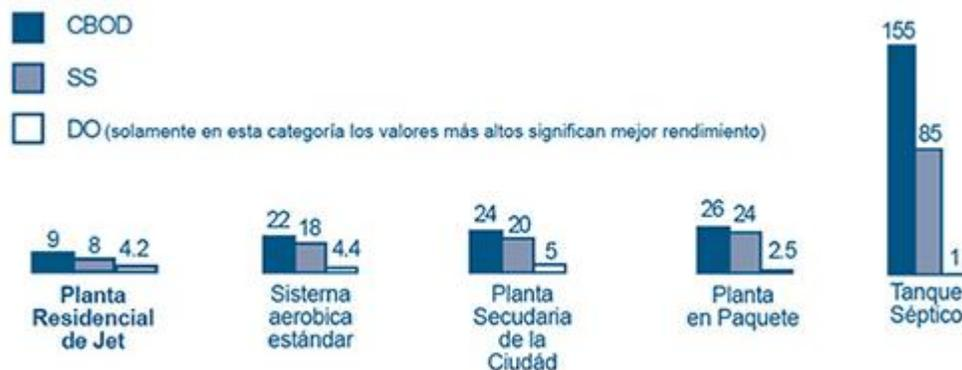
Figura 12. Comparación de datos del efluente en distintos sistemas
