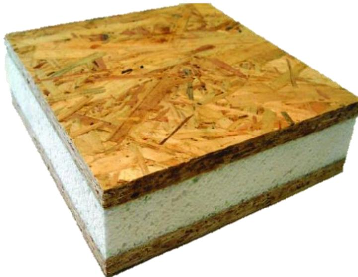
Figura 9. Panel estructural con aislamiento
