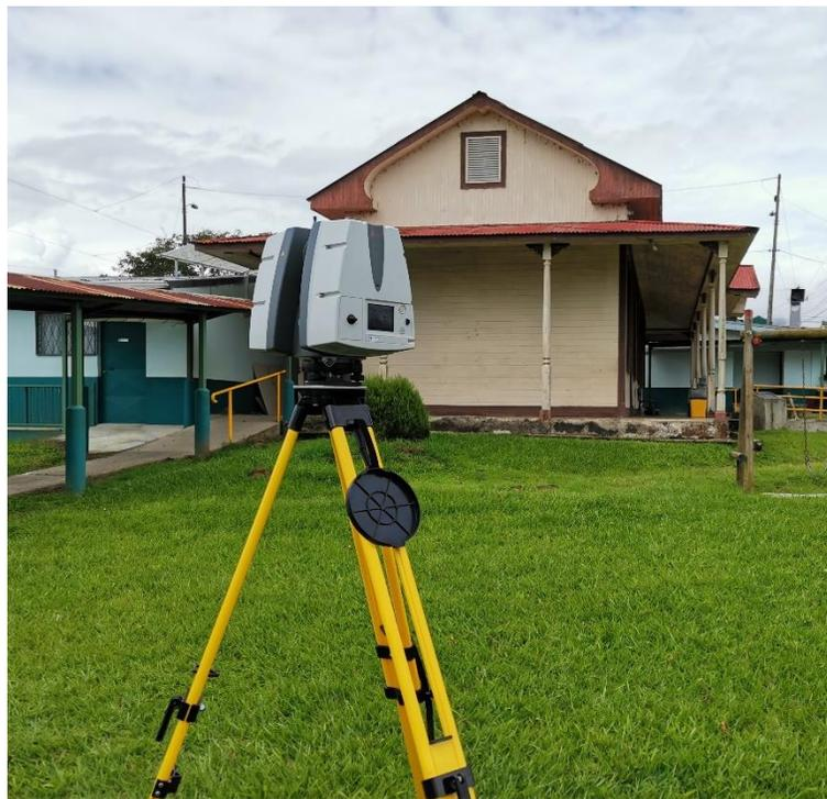
Figura 8. Estación de Escaneo P40
