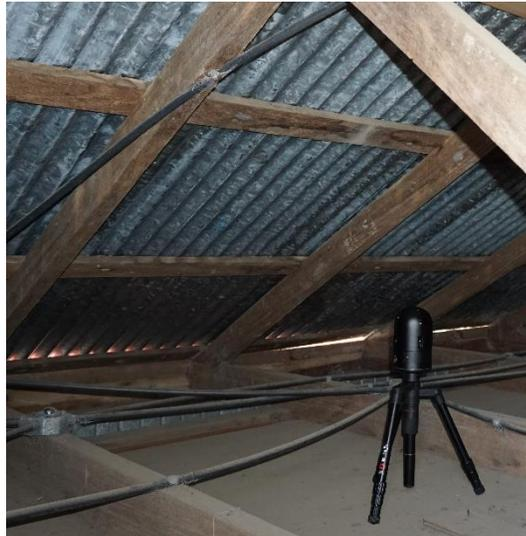
Figura 9. Escáner láser de imágenes Leica BLK360
