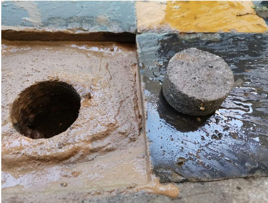
Figura 21. Muestra extraída del contrapiso
