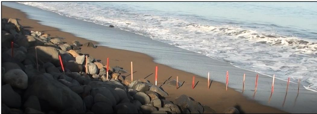
**Figura 3-11. Fotografía de las estacas colocadas para la medición de la llegada del oleaje a la playa**
