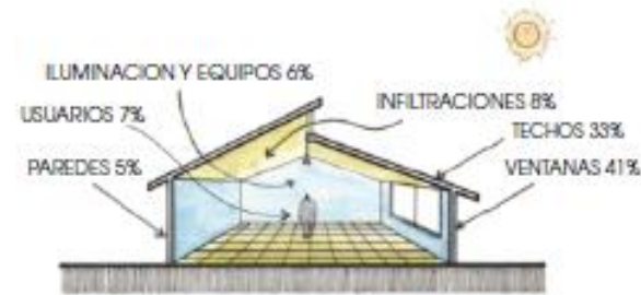
FIG. 7 Proporción de transmisión de calor a través de los componentes de una edificación
