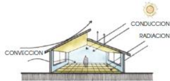
FIG. 6 Intercambio térmico del edificio con el ambiente.
