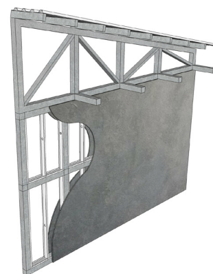
Imagen 64 - Estructura de cubierta en acero
