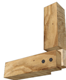
Imagen 51 - Sistema de union en madera
