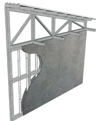
Imagen 102 - Estructura de cubierta en acero
