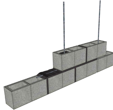
Imagen 112- Montaje mampostería de concreto
