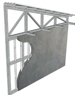
Imagen 133 - Estructura de cubierta en acero
