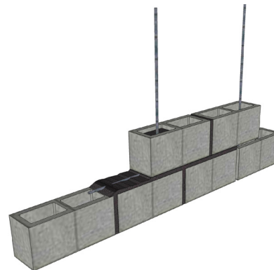
Imagen 76- Montaje mampostería de concreto
