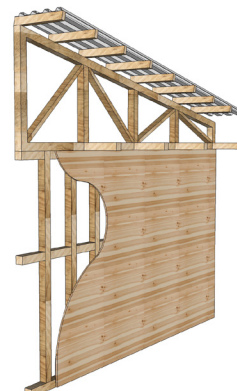
Imagen 53 - Estructura de cubierta - madera
