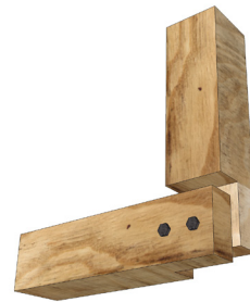
Imagen 121 - Sistema de union en madera
